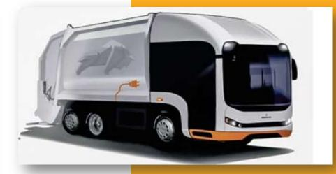
Опытный образец автомобилямусоровоза с автономным тяговым электрическим приводом и пониженным уровнем кабины.
