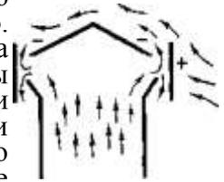
Воздух, поступающий в цех при аэрации, может быть подвентрирован охлаждению путем тонкого распыления воды с помощью форсунок в плоскости приточных проемов. Испаряясь, вода понижает температуру окружающего воздуха и несколько повышает его влажность. Применение искусственного охлаждения приточного воздуха аэрационных устройств особенно важно в южных районах страны.
